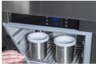
2. Frieren Sie Ihr Produkt mit dem Edelstahlbehalter bei einer Temperatur von  $-18^{\circ}/-20^{\circ}\text{C}$  ein.
