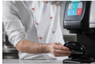
3. Fräser-Klinge mit dem schwarzen Behälterdeckel in den ROWZERPLUS einsetzen.
