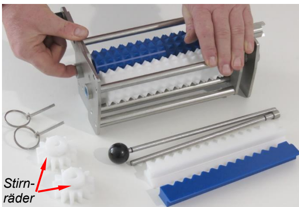
Abb. 139: Mürbewelle A (links) und B (rechts) herausziehen
