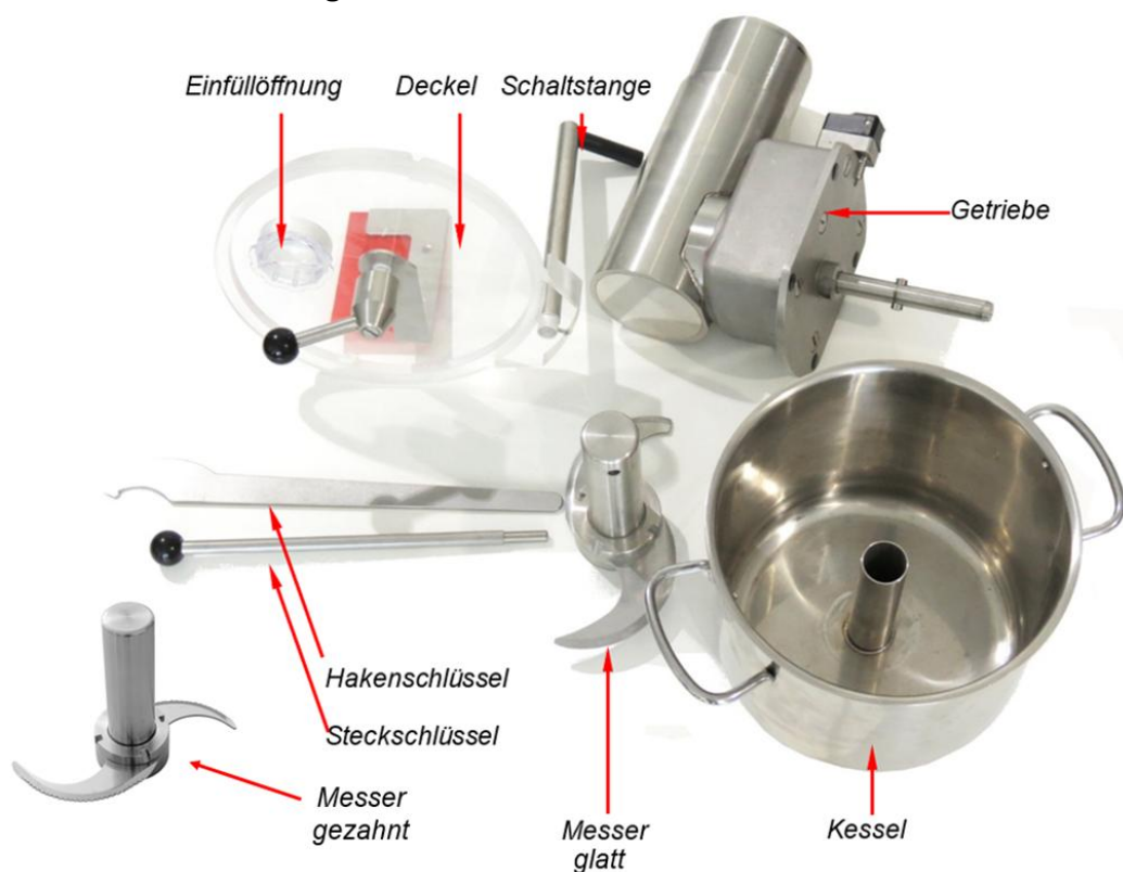
Abb. 110: Aufbau des Cutteraufsatzes HU CA 5.5 L
