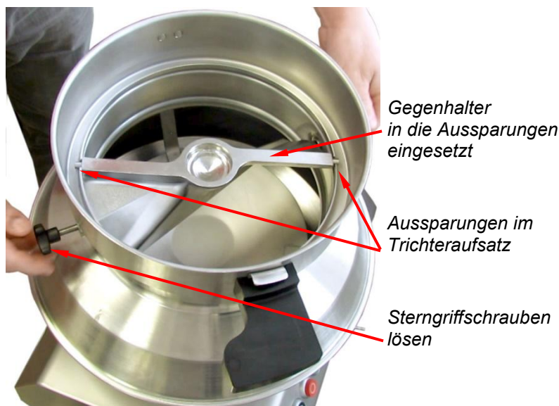
Abb. 65: Gegenhalter einsetzen
