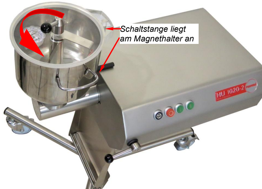
Abb. 113: Deckel verdrehen, bis Schaltstange am Magnethalter anliegt
