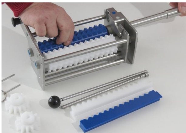
Abb. 142: Montieren der Mürbewelle A
