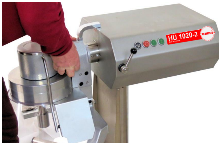
Abb. 103: Planeten-, Rühr-, Schlag-, und Knetwerk in die Kupplungsbohrung einstecken
