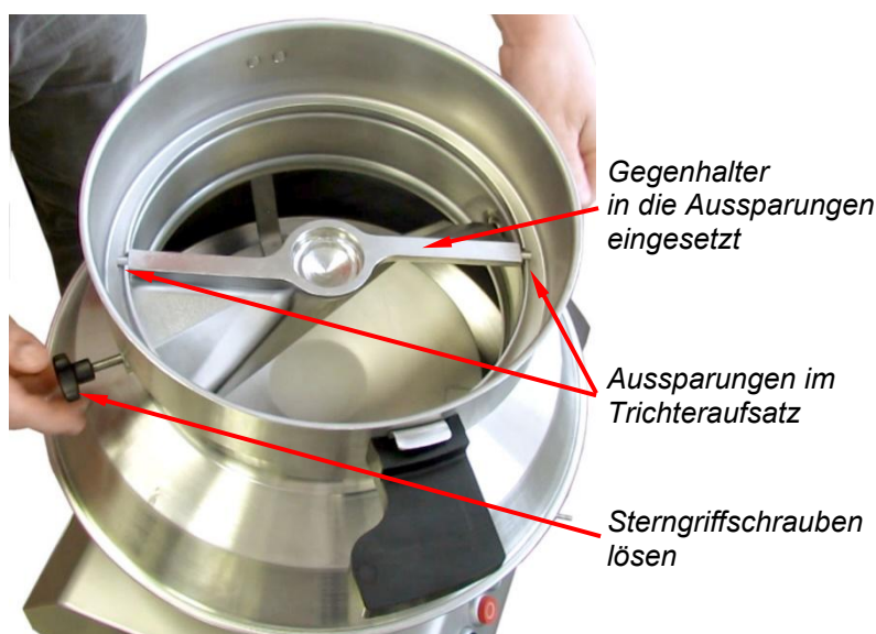
Abb. 67: Gegenhalter einsetzen
