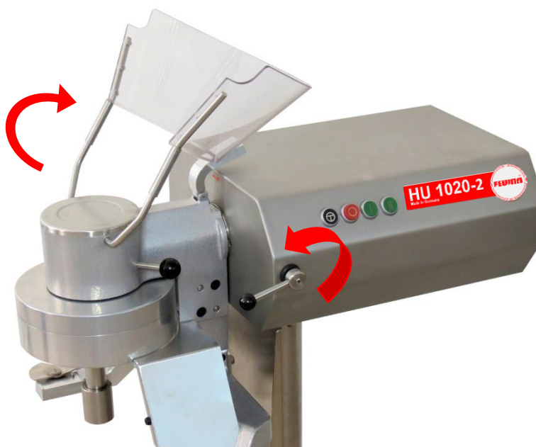
Abb. 104: Verriegelungshebel ist nach unten geschwenkt und Haube nach oben geklappt
