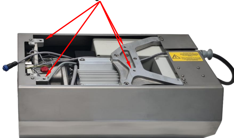
Abb. 33: Befestigungsmöglichkeit der Antriebseinheit AE 20-2H / AE 40-H
