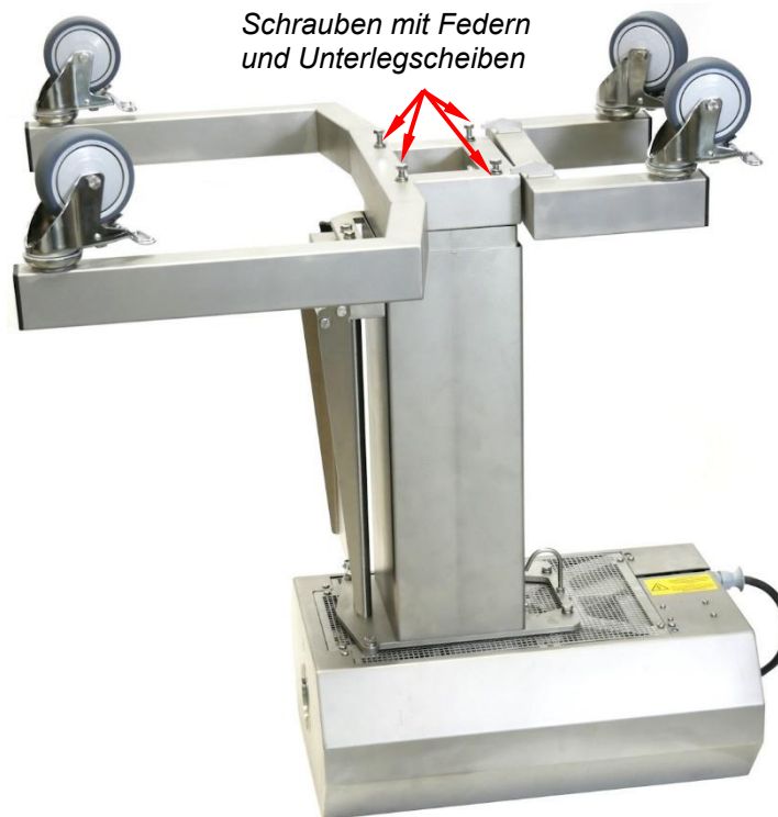
Abb. 44: Schrauben im Untergestell vormontiert
