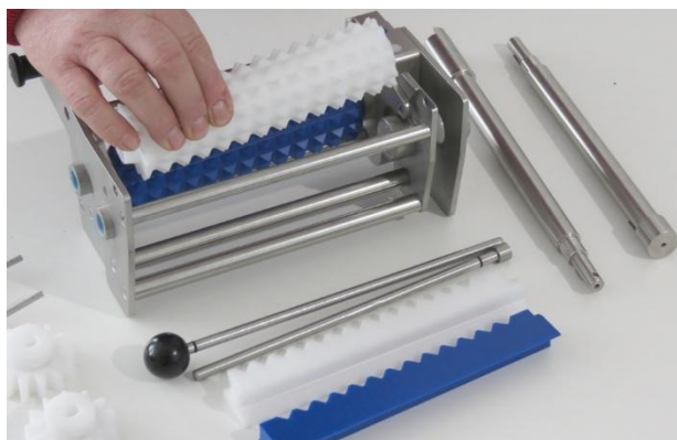
Abb. 140: Mürbewalze B (links) und A (rechts) entnehmen
