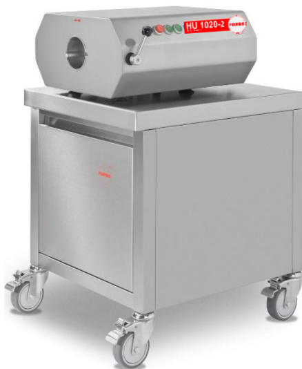
Abb. 46: Beispiel für die Montage der Antriebseinheit AE 20-2 auf einem Unterschrank
