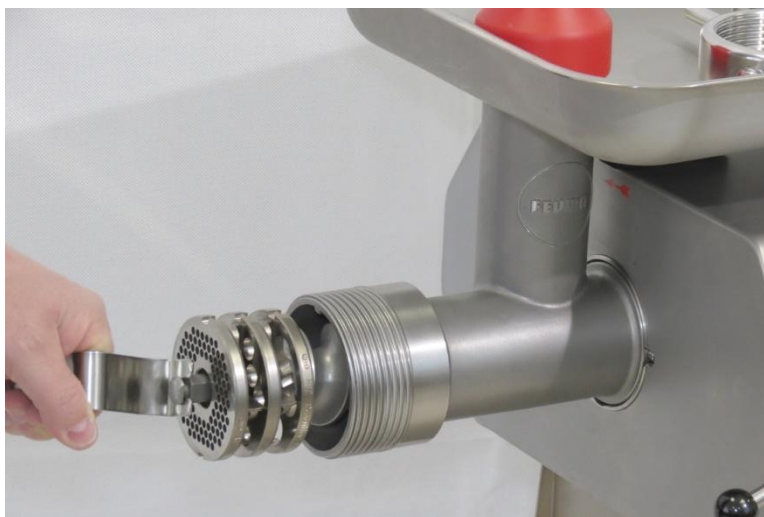
Abb. 83: Demontage des Schneidsatzes mit dem Ausziehhaken
