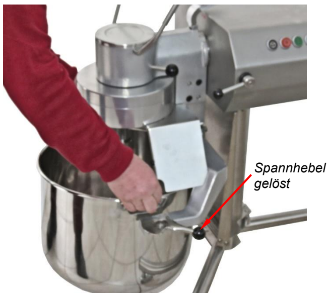
Abb. 109: Spannhebel sind gelöst, Kessel wird entnommen
