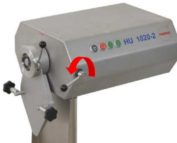
Abb. 88: Adapter HU 1020-2 an die Antriebseinheit angesteckt und verriegelt
