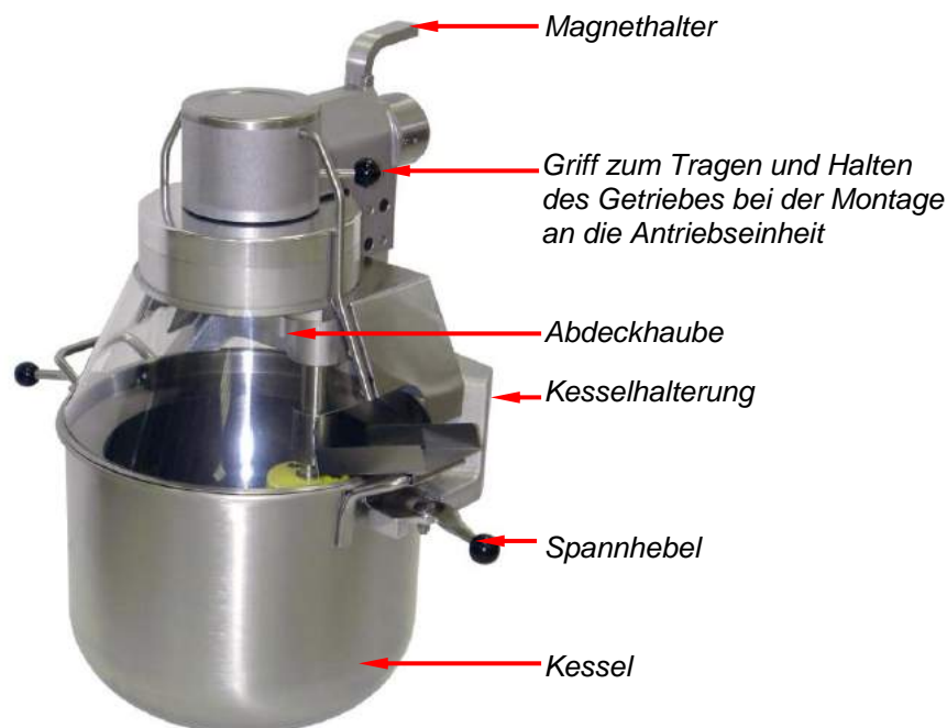
Abb. 76: Aufbau eines Planeten Rühr-, Schlag-, und Knetwerks am Beispiel UP 40-S
