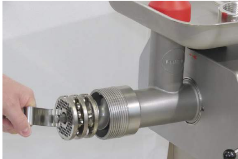
Abb. 47: Demontage des Schneidsatzes mit dem Ausziehhaken
