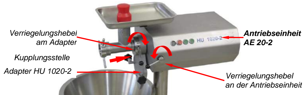
Abb. 64: Montage des Fleischwolfs an der Antriebseinheit
