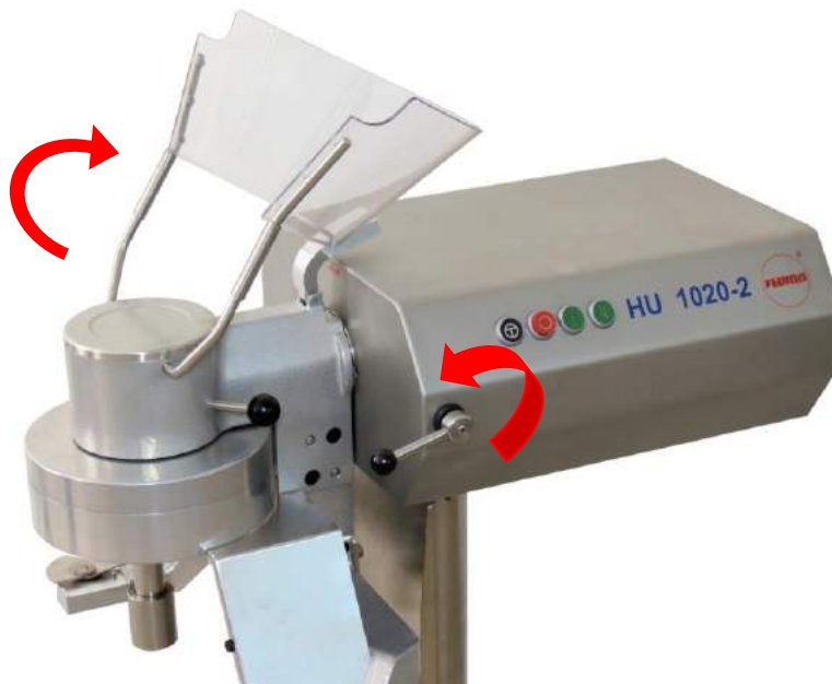
Abb. 78: Verriegelungshebel ist nach unten geschwenkt u. Haube nach oben geklappt
