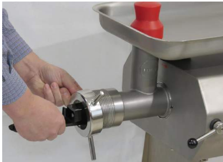
Abb. 57: Füllträger einsetzen und mit Überwurfmutter befestigen
