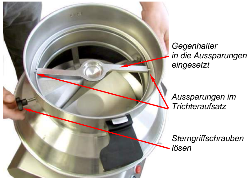
Abb. 29: Gegenhalter einsetzen
