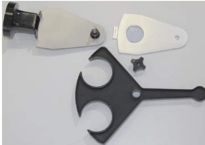
Abb. 51: Füllplatte 80/100 g abnehmen
