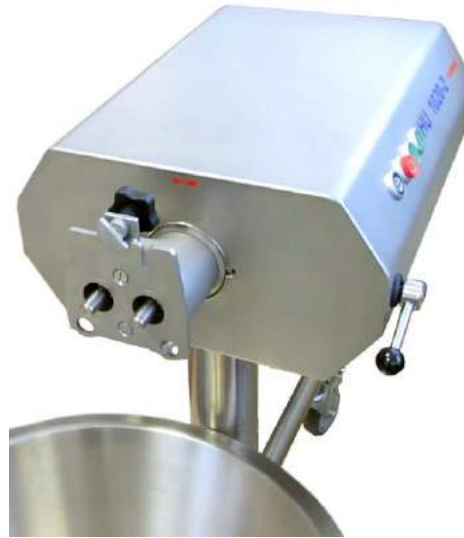
Abb. 72: Ansteckgetriebe an der Antriebseinheit angekuppelt und verriegelt
