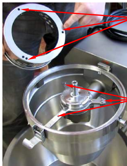
Abb. 23: Lochanordnung des Zylinders beim Aufsetzen auf die Stifte beachten
