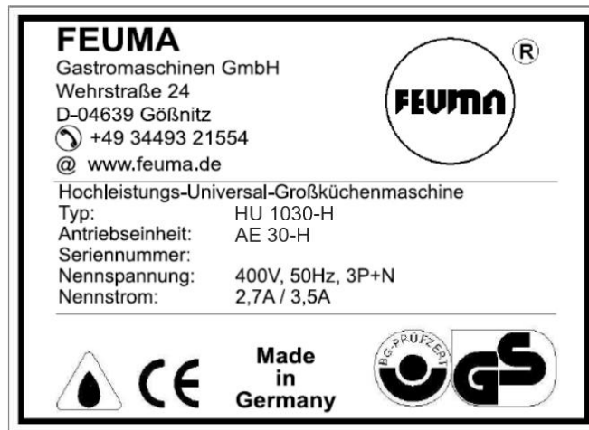
Abb. 1: Typenschild der Hochleistungs-Universal-Großküchenmaschine HU 1030-H (Bsp.)
