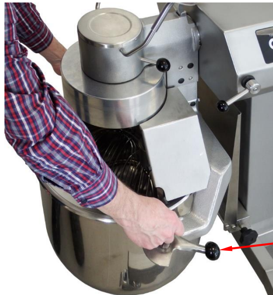
Abb. 111: Spannhebel sind gelöst, Kessel wird entnommen
