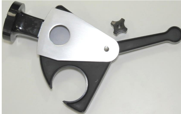
Abb. 74: Drehgriff der Positioniereinrichtung PE abschrauben.
