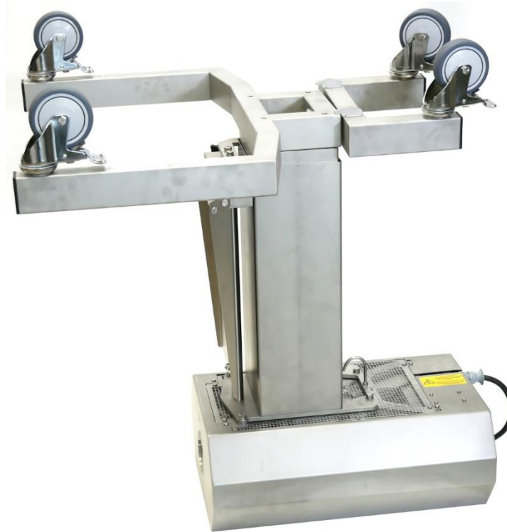
Abb. 36: Untergestell auf der Höhenverstellung aufgelegt
