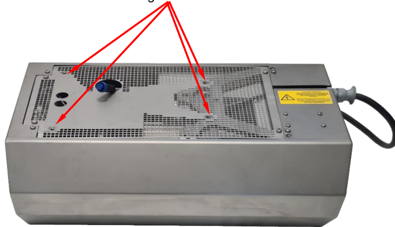
Abb. 26: Befestigungsmöglichkeit der Antriebseinheit AE 30-H
