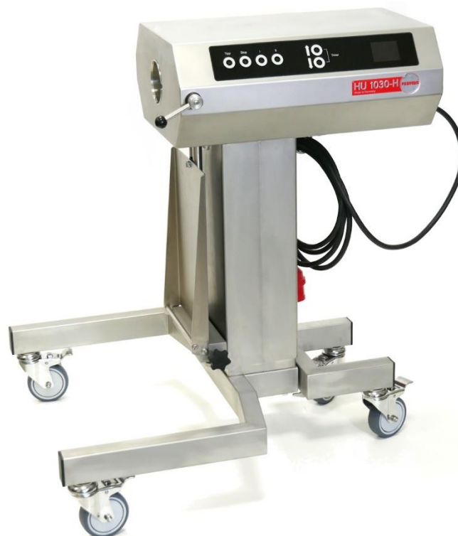
Abb. 38: Befestige Antriebseinheit AE 30-H auf dem Untergestell
