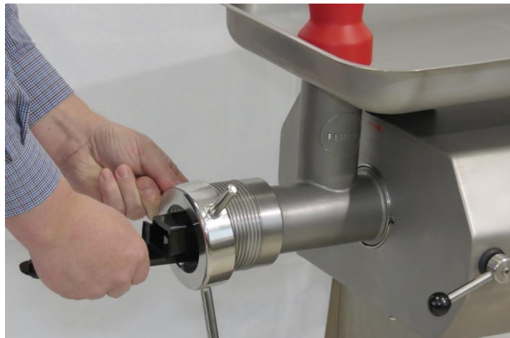
Abb. 82: Füllträger einsetzen und mit Überwurfmutter befestigen
