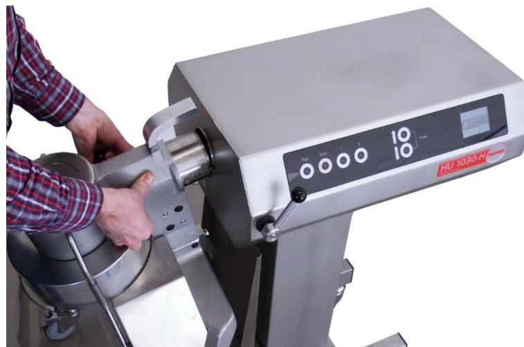
Abb. 105: Planeten-, Rühr-, Schlag-, und Knetwerk in die Kupplungsbohrung einstecken
