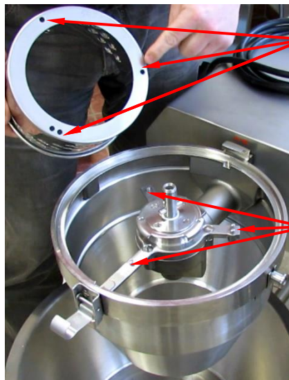
Abb. 47: Lochanordnung des Zylinders beim Aufsetzen auf die Stifte beachten
