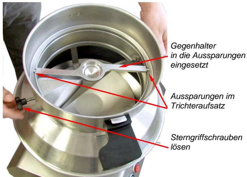
Abb. 53: Gegenhalter einsetzen
