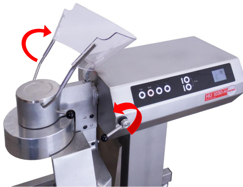
Abb. 106: Verriegelungshebel ist nach unten geschwenkt und Haube nach oben geklappt
