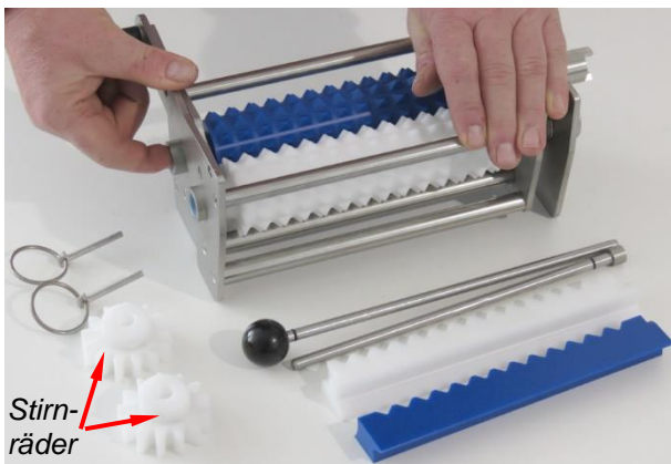
Abb. 142: Mürbewelle A (links) und B (rechts) herausziehen
