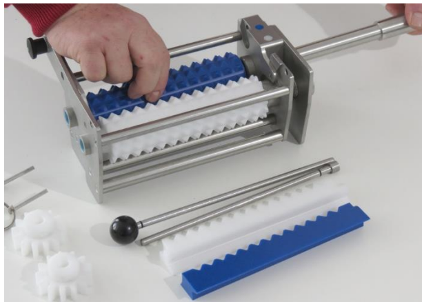
Abb. 145: Montieren der Mürbewelle A
