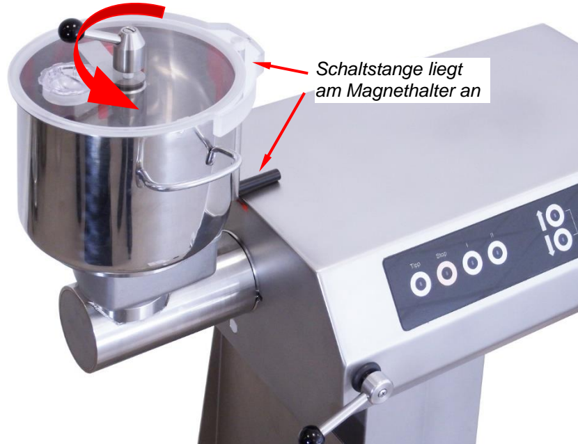
Abb. 115: Deckel verdrehen, bis Schaltstange am Magnethalter anliegt
