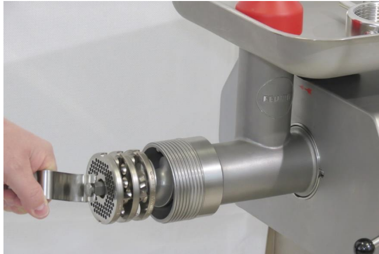
Abb. 72: Demontage des Schneidsatzes mit dem Ausziehhaken
