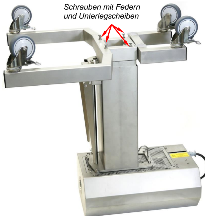
Abb. 37: Schrauben im Untergestell vormontiert
