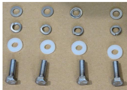
Abb. 27: Schrauben zur Befestigung der Antriebseinheit AE 30-H
