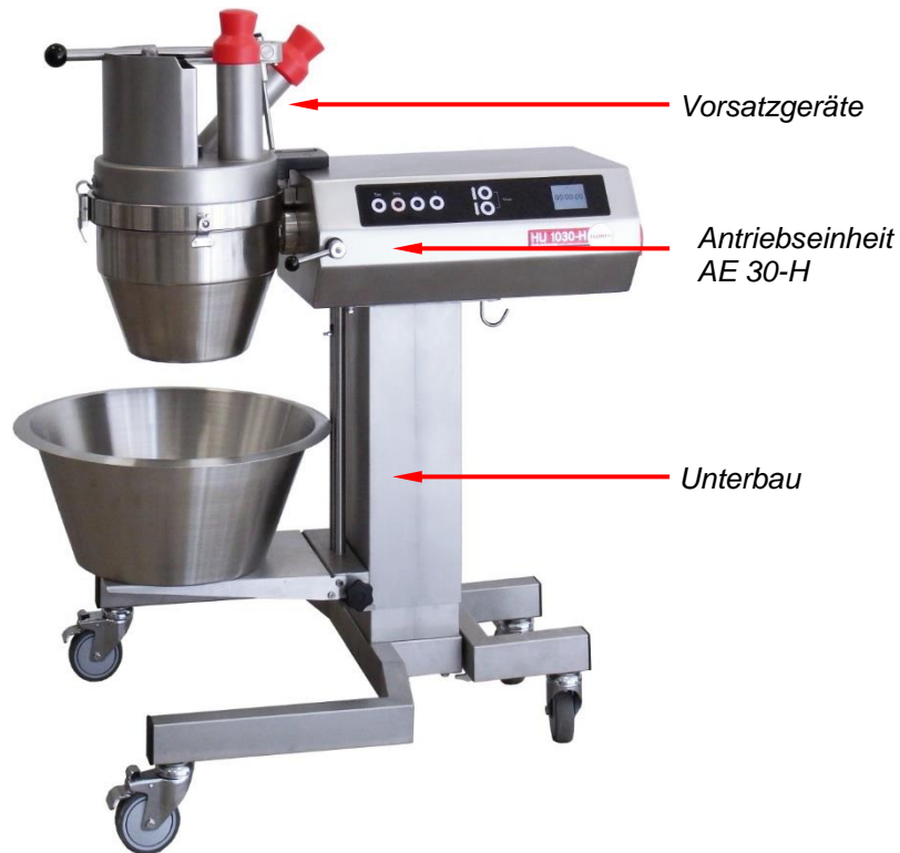
Abb. 2: Grundlegender Aufbau der Hochleistungs-Universal-Großküchenmaschine
