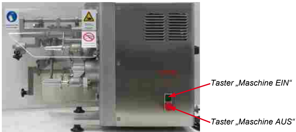
Abb. 49: Taster der Maschine für „EIN“ und „AUS“
