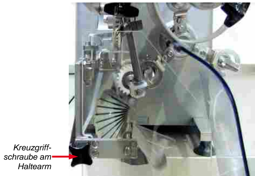
Abb. 36: Kreuzgriffschraube am Haltearm montiert
