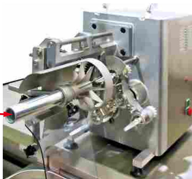
Abb. 43: Abführrohr auf Zerteilstern aufgesteckt
