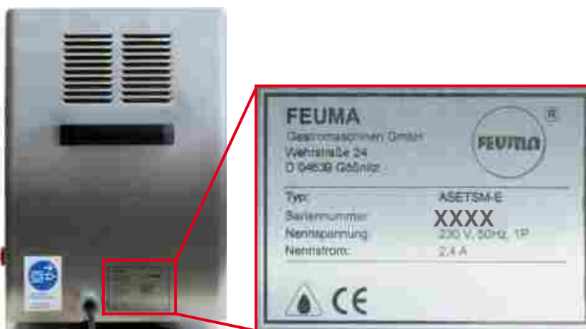
Abb. 2: Typenschild ASETSM an der Maschinenrückseite (Beispiel)
