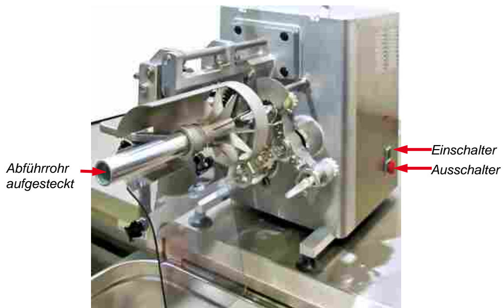
Abb. 29: Abführrohr auf Zerteilstern aufgesteckt
