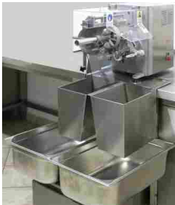
Abb. 62: Maschine mit Trennsystem (Artikel-Nr.: 542752) und Gastronormbehältern (EN 631 1/1)
