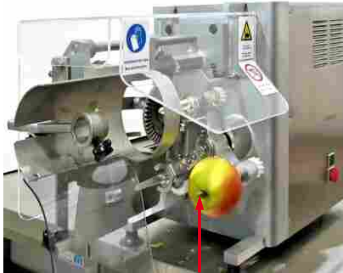
Verletzungsgefahr an der Fruchtaufnahme mit aufgestecktem Apfel
