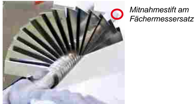
Abb. 44: Einbaulage des Fächermessersatzes
