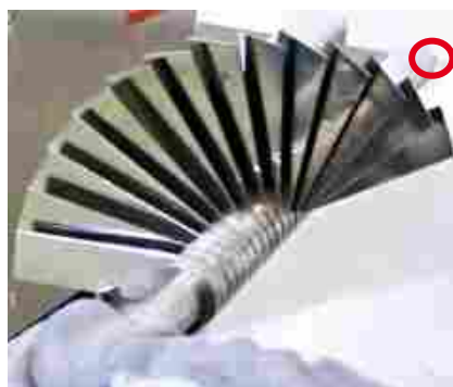
Abb. 33: Einbaulage des Fächermessersatzes
